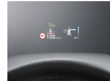
Проекция показаний приборов на лобовое стекло
