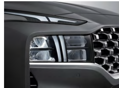
LED-фары рефлекторного типа
